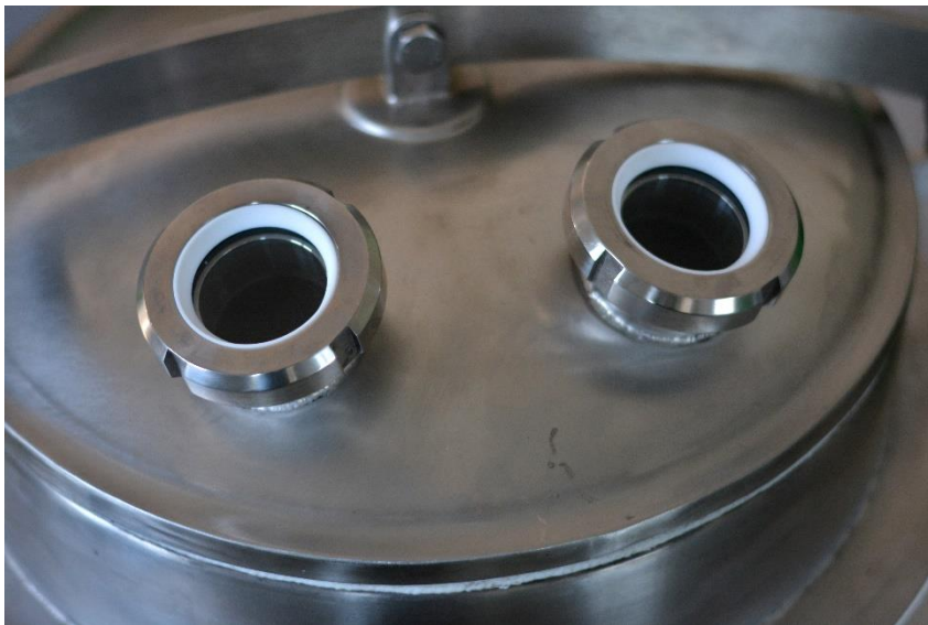
Okna rewizyjne w pokrywie
